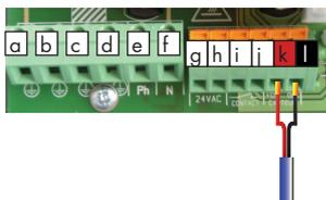
Raccorder le capteur de pression en respectant sa polarité :
