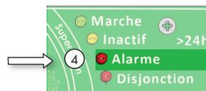
L'état d'alarme disparaît lorsque le niveau redescend au dessous du seuil de déclenchement du flotteur alarme.
