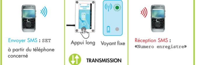
L'appui sur le bouton (4) doit être maintenu jusqu'à ce que le voyant (2) s'allume en vert fixe. La liste d'appel peut accepter 4 numéros. Au delà, la **Warning-Box** accuse réception avec le SMS suivant: «Erreur de traitement: liste d'appel pleine.»
