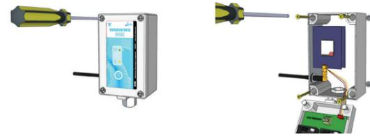
Ce kit est prévu pour une fixation dans du matériau dur (béton, agglo, pierre...) ; pour tout autre support, utilisez des chevilles adaptées. La **Warning-Box** se positionne en mode portrait presse-étoupe vers le bas. Elle doit être installée sous abri.
