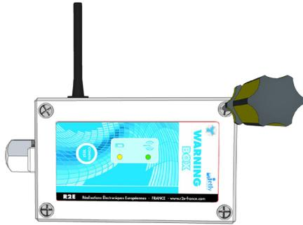
Dévisser les 4 vis du boîtier de la WARNING-BOX et ouvrir le couvercle.
