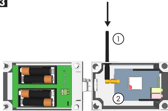
Appuyer sur l'antenne ① et faites pivoter le bloc ② afin de l'extraire de la Warning-Box.
